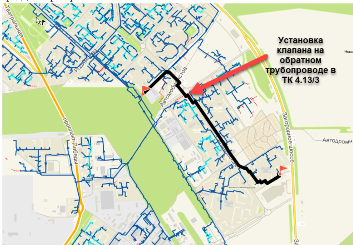
Рисунок 5 – Место монтажа клапана регулировки напора в обратном трубопроводе
