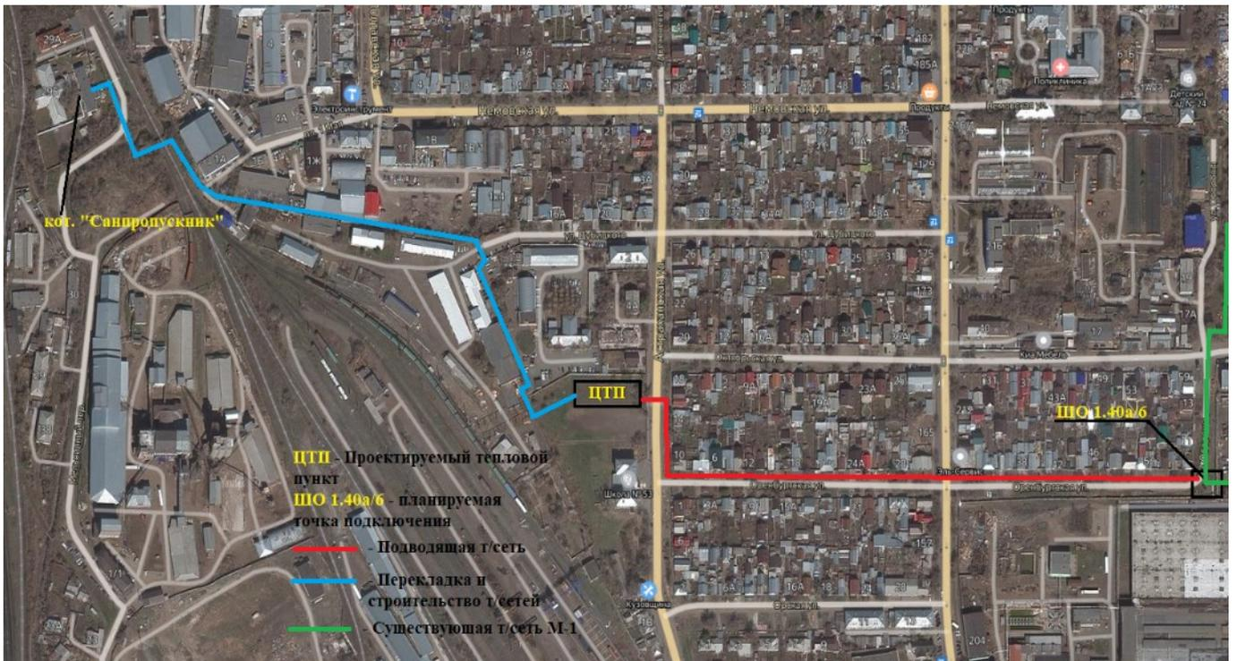
Рисунок 10 – Схема расположения ЦТП и строительство тепловых сетей
