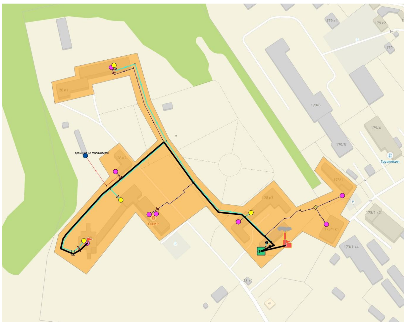
Рисунок 69 - Путь движения теплоносителя от источника тепловой энергии до конечного потребителя
