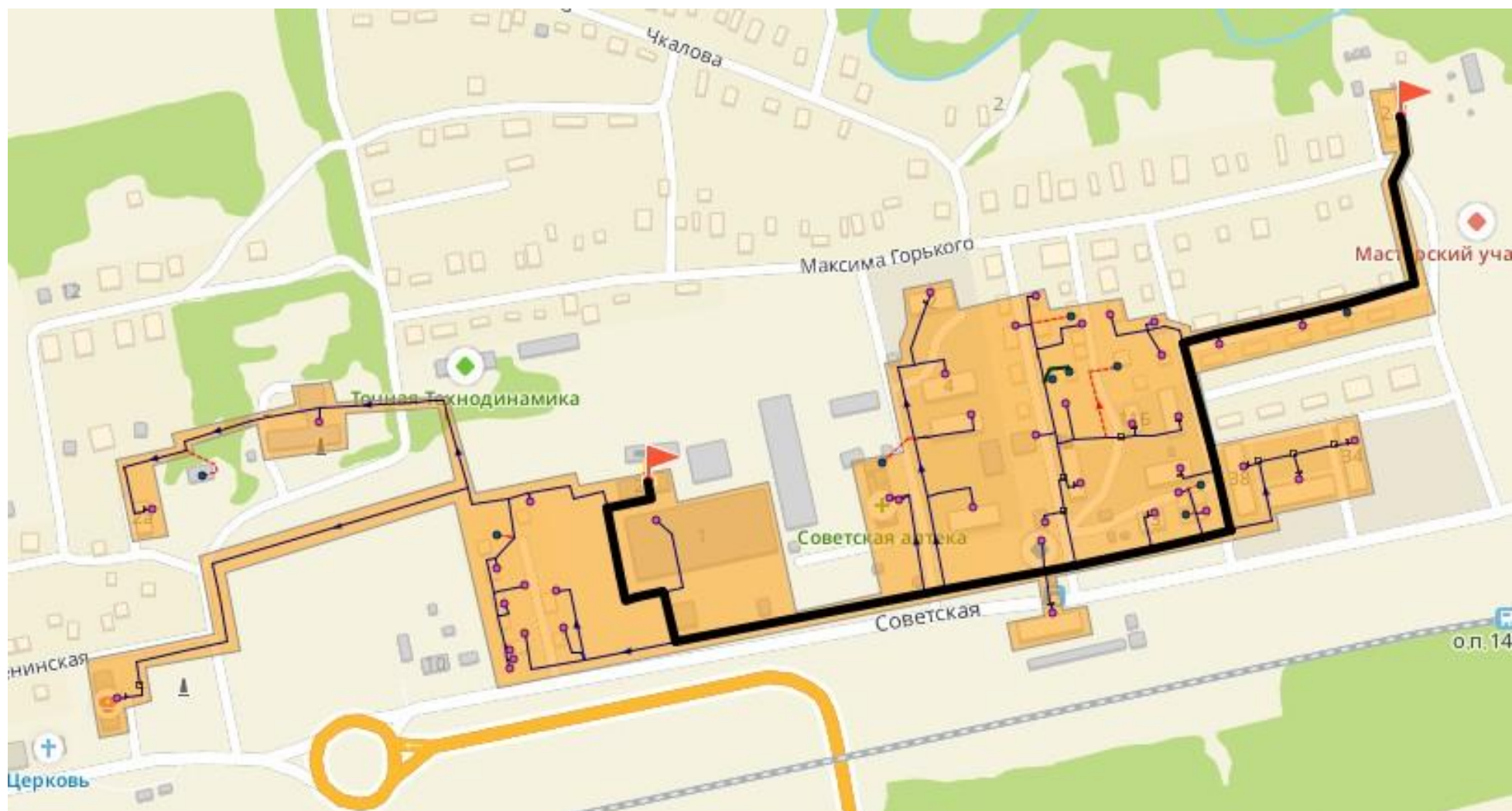
Рисунок 87 - Путь движения теплоносителя от источника тепловой энергии до конечного потребителя
