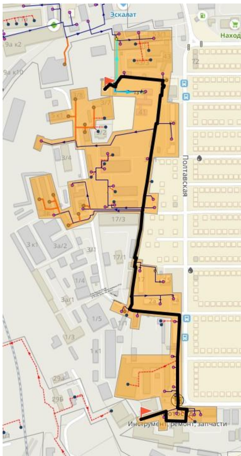
Рисунок 67 - Путь движения теплоносителя от источника тепловой энергии до конечного потребителя
