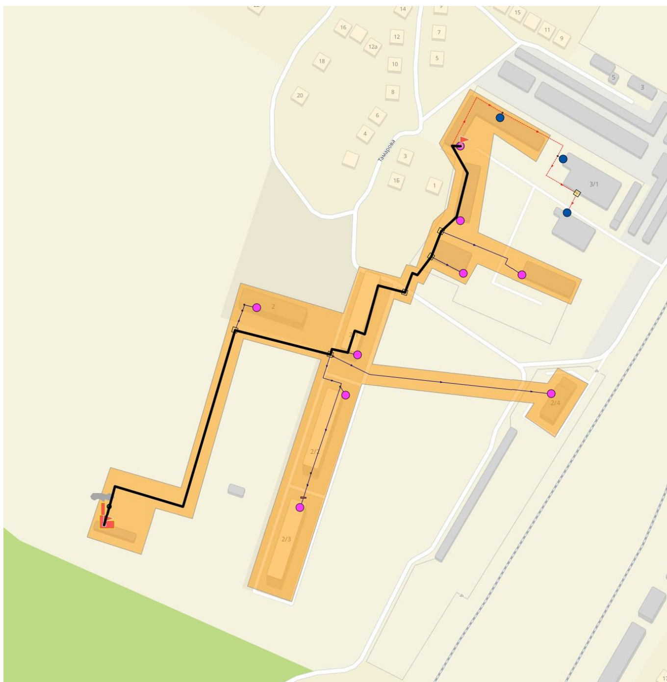
Рисунок 81 - Путь движения теплоносителя от источника тепловой энергии до конечного потребителя
