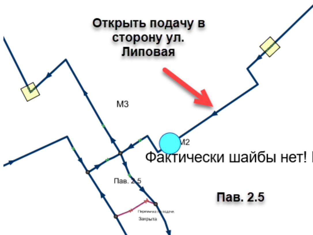
Рисунок 110 – Переключения между магистралями при аварийном отключении М2
