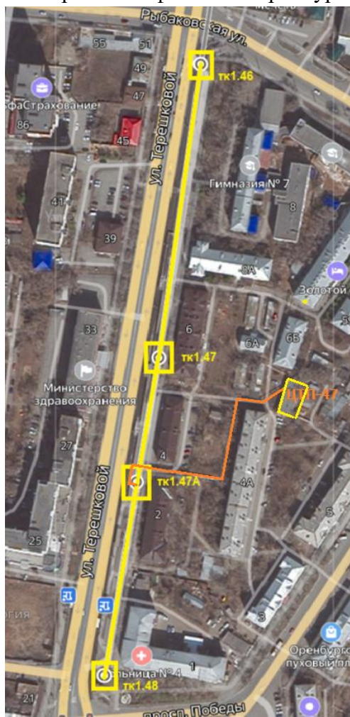
Рисунок 24 – Ситуационный план – реконструкция теплотрассы М1 - участок от ТК 1.46 до ТК 1.48 (с вводом в ЦТП-47)
