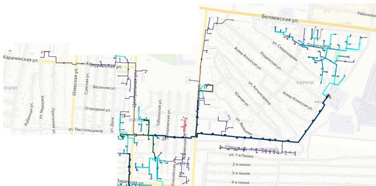
Рисунок 29 – Ситуационный план – реконструкция КТС от котельной Карачи
