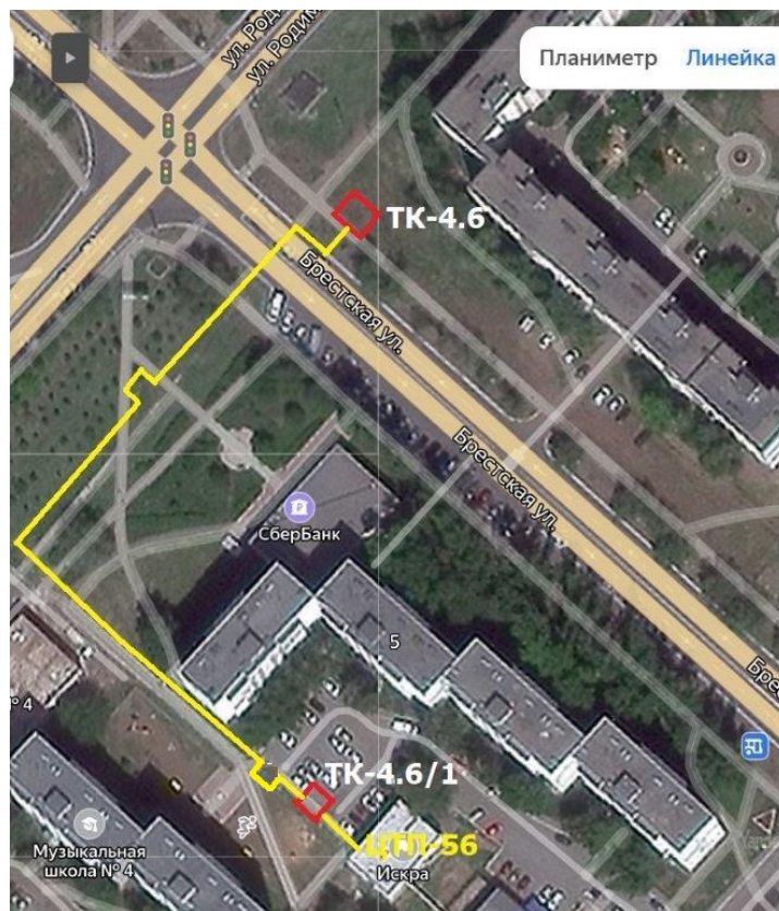
Рисунок 21 – Ситуационный план – реконструкция теплотрассы М4 - участок от ТК-4.6 до ЦТП-56
