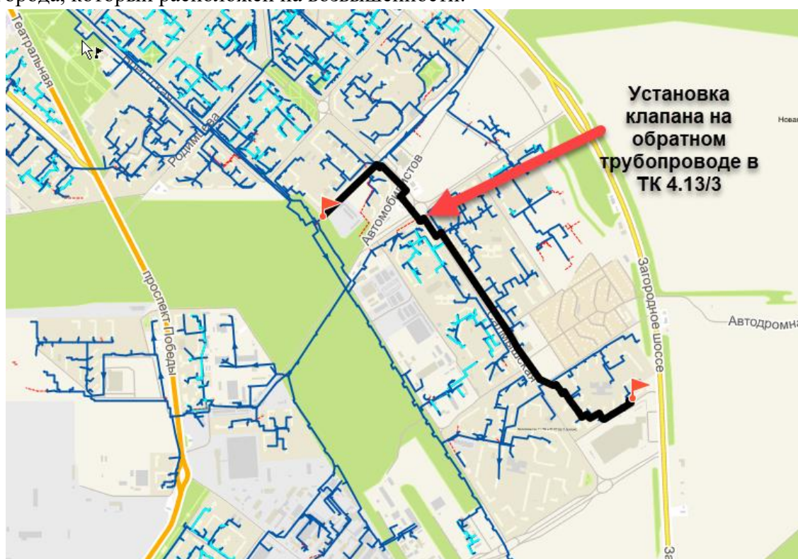
Рисунок 2 – Место монтажа клапана регулировки напора в обратном трубопроводе
