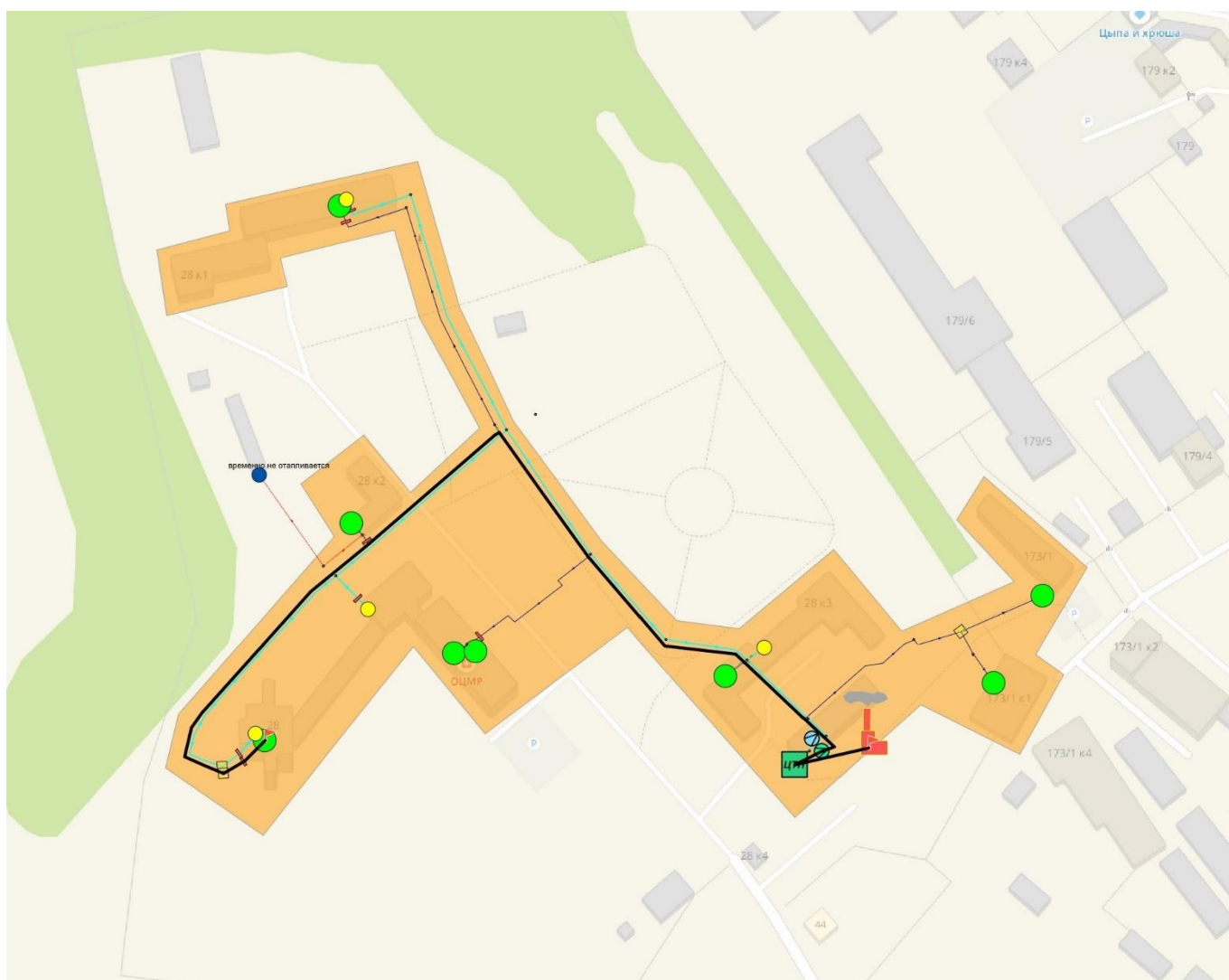
Рисунок 68 – Путь движения теплоносителя от источника тепловой энергии до конечного потребителя
