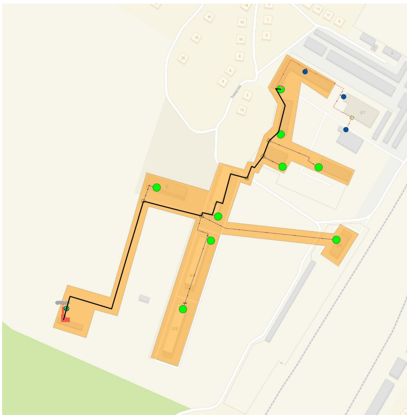
Рисунок 76 – Путь движения теплоносителя от источника тепловой энергии до конечного потребителя
