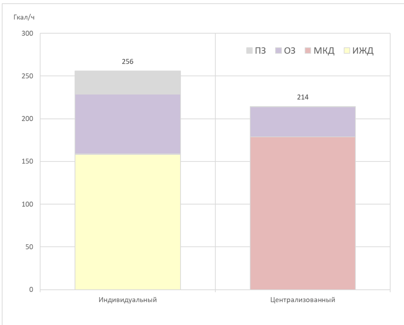
Рисунок 13 – Распределение прироста перспективной тепловой нагрузки между типами источников тепловой энергии по типам застройки, Гкал/ч
