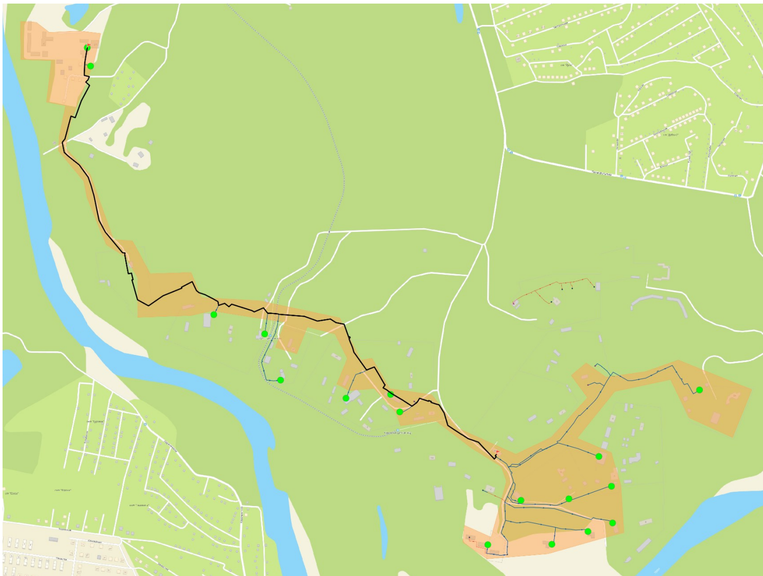
Рисунок 31 – Путь движения теплоносителя от источника тепловой энергии до конечного потребителя
