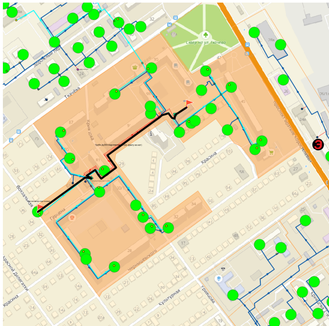
Рисунок 19 – Путь движения теплоносителя от источника тепловой энергии до конечного потребителя
