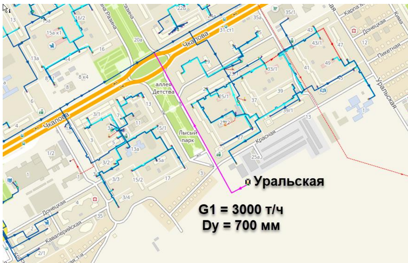
Рисунок 2 – Расположение пиковой котельной «Уральская» и её подключение к тепловым сетям Сакмарской ТЭЦ (М4), Расход 3000 т/ч – максимально возможный
