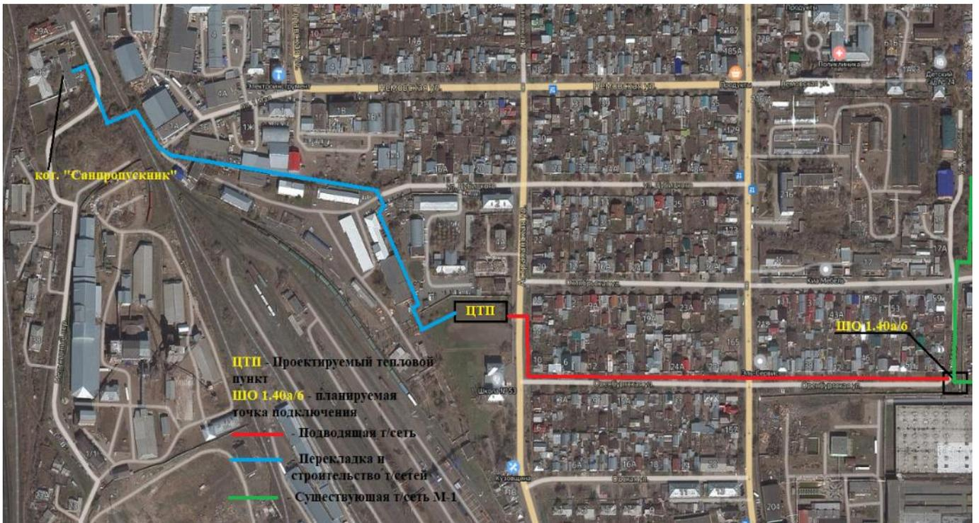
Рисунок 6 – Схема расположения ЦТП и строительство тепловых сетей
