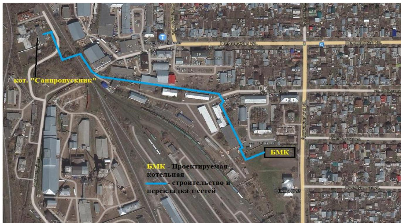
Рисунок 5 – Схема расположения БМК и строительство тепловых сетей
