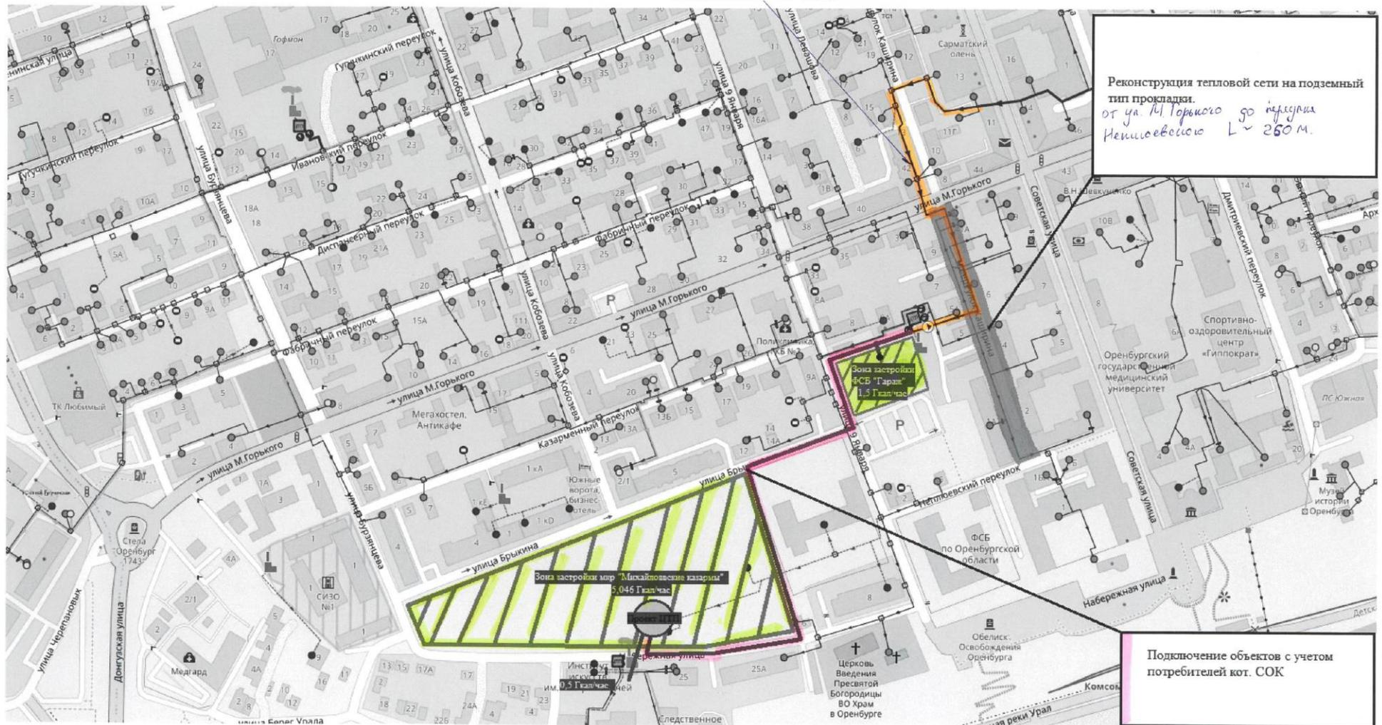
Рисунок 8 – Перекладка тепловой сети, расположенной по пер. Каширина, в подземное исполнение
