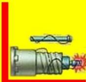
**2** Применять в аппаратах защиты электросетей не калиброванные плавкие вставки (скрутки проволоки, «жучки»).
