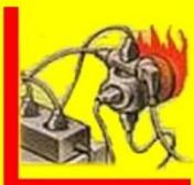
**1** Перегружать электрические сети, эксплуатировать провода и кабели с поврежденной и утратившей свои защитные свойства изоляцией.
