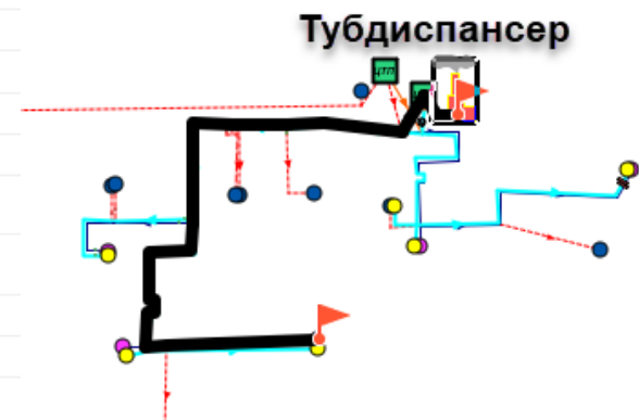
Рисунок 37 – Пьезометрический путь от котельной «Тубдиспансер» до наиболее отдалённого потребителя. Располагаемый напор 21 м вод.ст.
